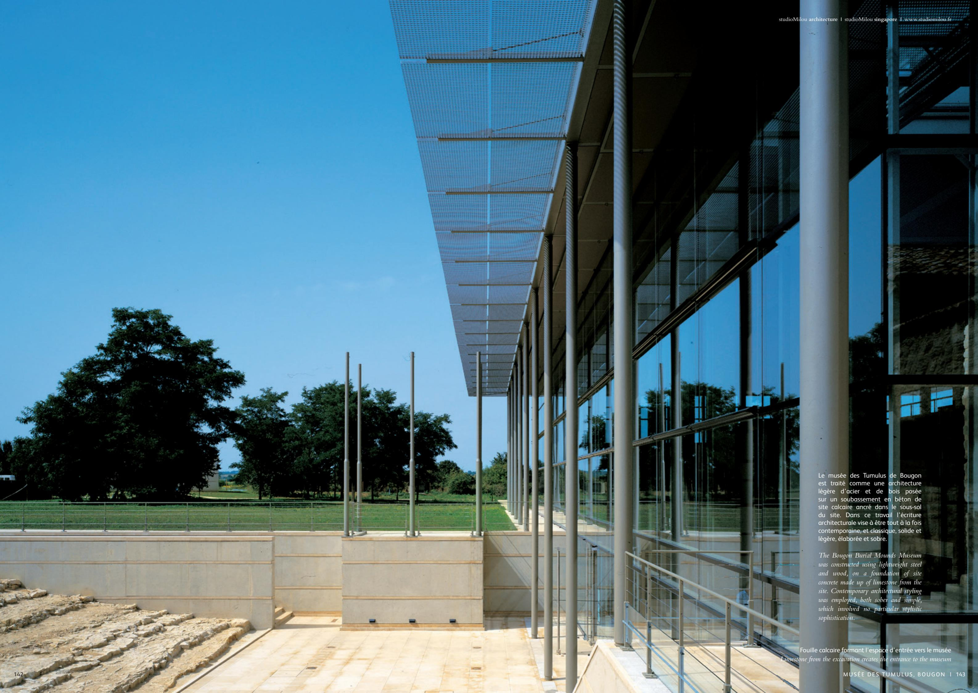
Le musée des Tumulus de Bougon est traité comme une architecture légère d'acier et de bois posée sur un soubassement en béton de site calcaire ancré dans le sous-sol du site. Dans ce travail l'écriture architecturale vise à être tout à la fois contemporaine, et classique, solide et légère, élaborée et sobre.
