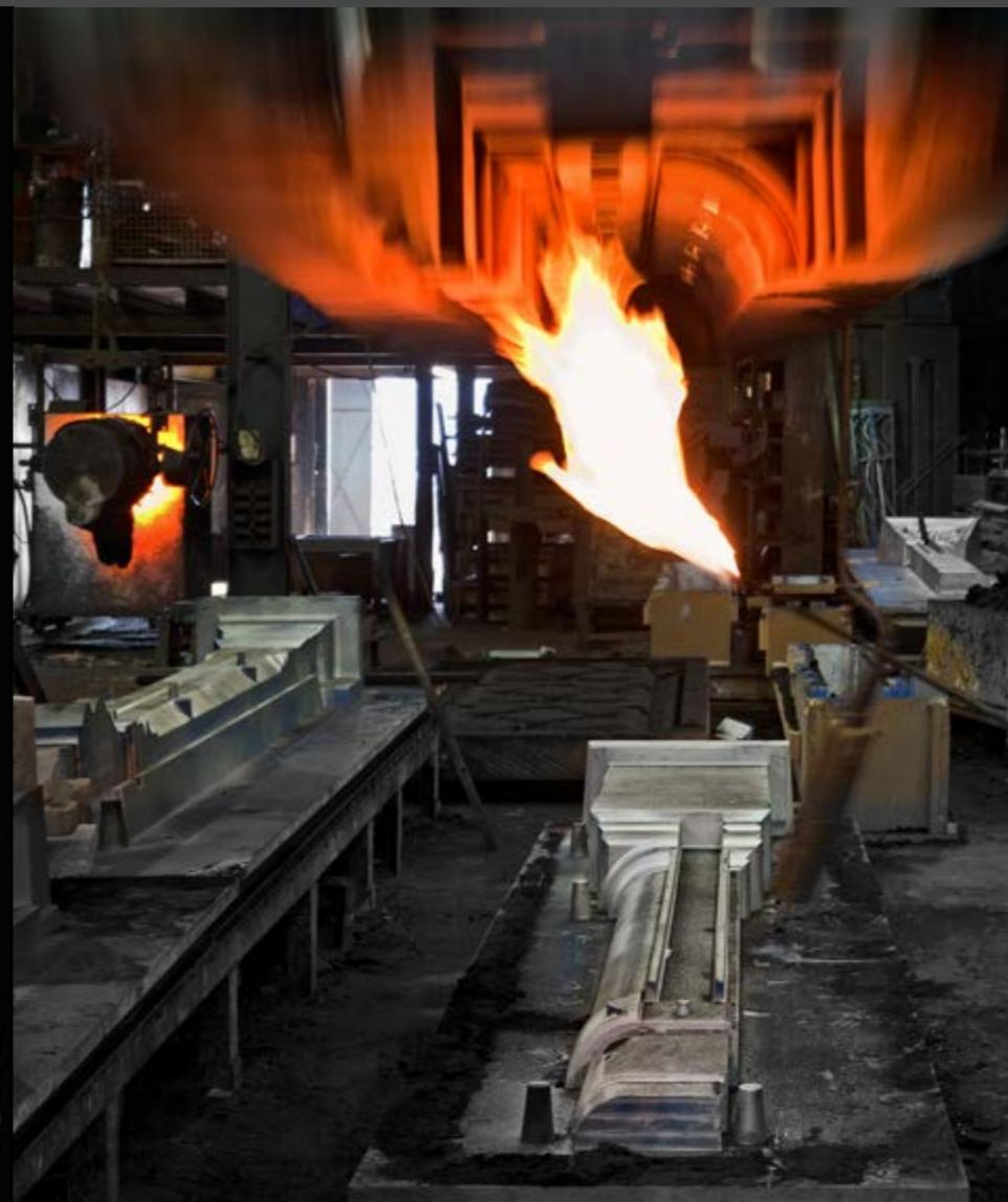
Moulage et réalisation des répliques des colonnes / Casting and realisation of column replicas (Fonderie Vincent)
